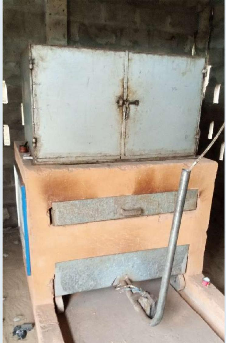
**Photo 63 :** Dispositif de fumage utilisant l'énergie solaire
