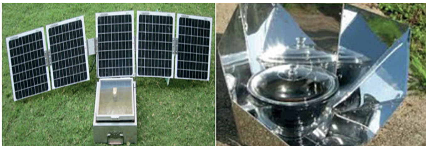
Figure 2. Exemple de foyers solaires en boîte (à gauche) et en panneau (à droite)
